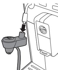
**1** Вийміть автоматичний спінювач молока з вузла подачі гарячої води/пари.
