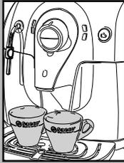
**i** In questa modalità di funzionamento, la macchina provvede automaticamente a macinare e dosare la giusta quantità di caffè. La preparazione di due caffè richiede due cicli di macinatura e due cicli di erogazione gestiti automaticamente dalla macchina; questa opzione viene segnalata dal led "☺" acceso fisso.
