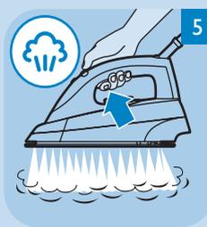
**5** Per stirare con il vapore, ruotate il termostato del ferro su ●● o su un valore superiore. Quindi premere il pulsante vapore **T**.
