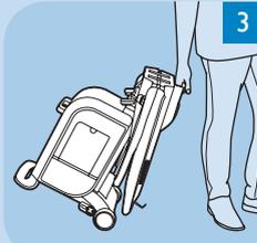
**3** È ora possibile spostare l'apparecchio tirandolo tramite la maniglia dell'asse.
