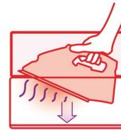
Esta caixa de arrumação resistente ao calor foi concebida para arrumar facilmente o ferro ainda quente. Para um desempenho otimizado e uma vida útil mais longa da sua caixa, desligue sempre a ficha do ferro e esvazie o depósito da água antes de arrumar o ferro na caixa. Quando coloca um ferro quente na caixa, a parte inferior da caixa também aquece no exterior, mas não há riscos desta queimar.
