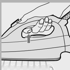
**2** 按住蒸汽按钮，直至不再听到任何蒸汽溢出熨斗的声音为止。
