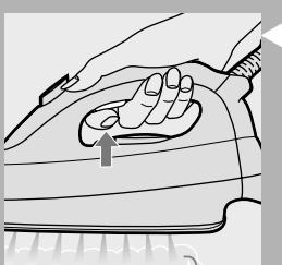
**3 进行蒸汽熨烫时请按住蒸汽按钮(H)。**
