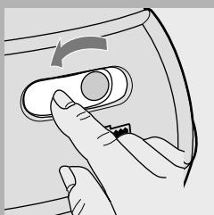
**1** 首先将on/off (开/关) 开关(D) 设置为off (关)。
