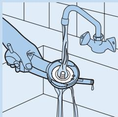
**4** Verificate che il pulsante di sgancio del tubo funzioni correttamente. Quando si preme il pulsante blu di sgancio del tubo, i due fermi dell'apertura si devono muovere.
