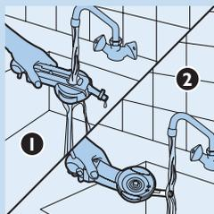
**3** Successivamente capovolgete il rubinetto e pulite la parte di collegamento sulla base del rubinetto stesso.
