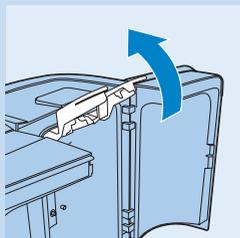
**2** Alzate completamente le due leve di bloccaggio blu.
