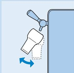
**4** Vous pouvez agir sur la quantité de mousse en faisant varier l'angle d'inclinaison du verre sous le bec de tirage et la distance entre le verre et le bec de tirage.
