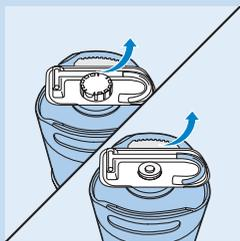
**2** Se presente, rimuovete il connettore del tubo e il tubo stesso dal rubinetto. Tenete il rubinetto sotto l'acqua corrente e sciacquate il foro di collegamento del tubo (1) e la parte di collegamento che si trova sul corpo dell'apparecchio (2). Se necessario utilizzate del liquido per piatti.
