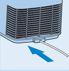
**2** Placez l'excédent de cordon dans le compartiment de rangement à l'arrière de l'appareil.
