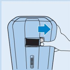
**1** Ouvrez les portes en appuyant sur les boutons déverrouillage.
