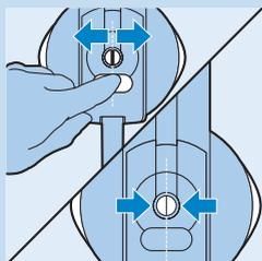
**5** Inserite il rubinetto sulla parte superiore di collegamento del barile spingendolo con decisione finché non scatta in posizione.
