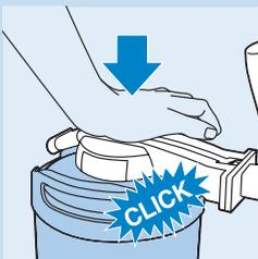
**5** Plaats de tapunit op het aansluitpunt boven op het biervat en druk de tapunit stevig omlaag ('klik').
