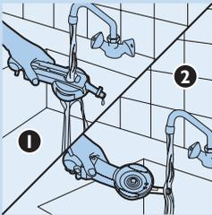
**2** Verwijder, indien aanwezig, het koppelstuk en het slangetje van de tapunit. Houd de tapunit onder de kraan en spoel het aansluitgat voor het slangetje (1) en het aansluitpunt van de unit op de behuizing van het apparaat (2) af. Gebruik indien nodig een beetje afwasmiddel.
