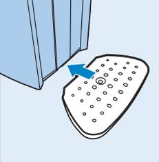
**4** HD3620: Setzen Sie die Auffangschale ein.
