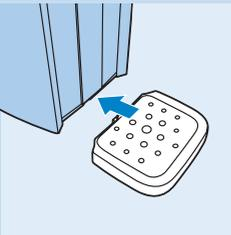
**5** HD3610: Setzen Sie die Auffangschale ein.
