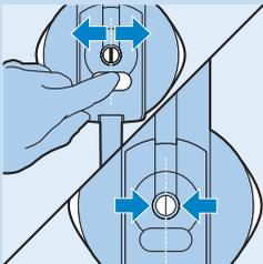
**4** Controleer of de slangontgrendelknop goed werkt. Wanneer u op de blauwe slangontgrendelknop drukt, moeten de twee klemmen in de opening bewegen.
