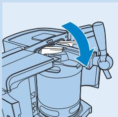
**4** Abaissez les leviers de verrouillage bleus jusqu'en position horizontale.
