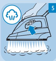
5 Ako želite glačati s parom, postavite regulator temperature na ●● ili višu postavku i pritisnite gumb za aktiviranje pare **T**.
