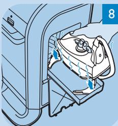
8 Vruće glačalo možete spremati u odjeljak za spremanje koji je otporan na toplinu neposredno nakon što ga isključite.
