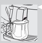
Une fois la phase de réchauffage terminée, la machine effectue un cycle automatique de rinçage/auto-nettoyage des circuits internes en utilisant de l'eau fraîche. L'opération demande moins d'une minute.
