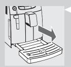
15 Pour nettoyer le bac d'égouttement, mettre une tablette de dégraissage dans le bac et le remplir avec 2/3 d'eau chaude. Laisser agir la solution de nettoyage pendant 30 minutes environ puis rincer abondamment.
