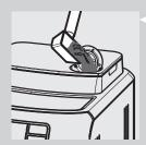
2 Soulever le couvercle du compartiment prévu à cet effet et ajouter une mesure de café prémoulu. Utiliser uniquement la mesure fournie avec la machine, refermer ensuite le couvercle du compartiment du café prémoulu.
