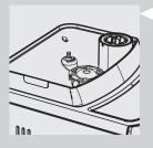
Nettoyer le réservoir à café en grains une fois par mois quand il est vide avec un chiffon humide afin d'éliminer les substances huileuses du café. Le remplir à nouveau avec le café en grains.
