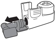
**4** Extraiga el conector del espumador de leche del dispositivo espumador de leche.
