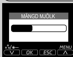
Genom att reglera statuslinjen på skärmen med hjälp av rullningsknapparna "V" eller "^" kan man välja den mängd mjölk som ska användas för den valda drycken. Tryck på OK för att bekräfta justeringen.
