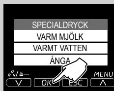
**3** Efter att ha valt VARMT VATTEN genom att trycka på rullningsknappen "V" eller "A", bekräfta med "OK".
