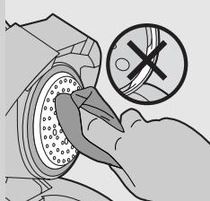
**11** Torka av vattenfordelningsplattan med en fuktig trasa.
