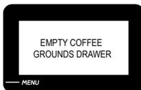
Trekk ut grutsamleren og tøm innholdet i en egnet beholder.
