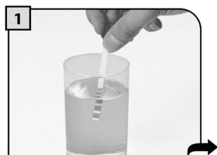
Dypp testpinnen for vannhardhet som følger med maskinen i vannet i 1 sekund.
