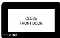
For å sette maskinen i drift må du stenge betjeningsluken.
