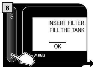
8 Trykk på tasten "OK" for å bekrefte innsetting av nytt filter.
