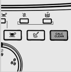
Durante a utilização, na parte interna da máquina forma-se calcário, que deve ser removido com regularidade; caso contrário, o circuito hidráulico e do café podem permanecer obstruídos. A própria máquina indicará quando houver necessidade de se realizar a descalcificação. Se o indicador luminoso led "CALC CLEAN" permanecer aceso de forma fixa, significa que é necessário realizar a descalcificação.
