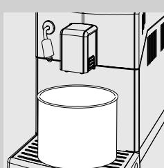
**6** Τοποθετήστε ένα μεγάλο δοχείο (1,5 l) κάτω από το σωλήνα ατμού/ζεστού νερού και κάτω από το ακροφύσιο καφέ.
