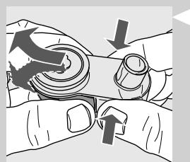
**19** Για να αποσυναρμολογήσετε το αυτόματο εξάρτημα για αφρόγαλα πίεστε στα πλαινά του και τραβήξτε κάνοντας ελαφρές πλευρικές κινήσεις όπως φαίνεται στην εικόνα.
