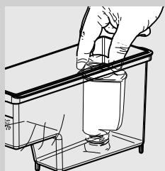
**18** Αφαιρέστε το μικρό λευκό φίλτρο και επανατοποθετήστε το φίλτρο νερού «INTENZA+» (αν έχει εγκατασταθεί) στο δοχείο νερού.
