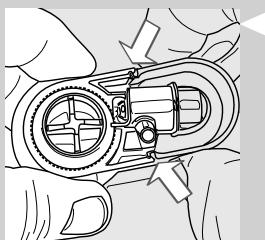
**23** Τοποθετήστε το αυτόματο εξάρτημα για αφρόγαλα στον σύνδεσμο και βεβαιωθείτε ότι έχει στερεωθεί καλά στα σημεία που επισημαίνονται.
