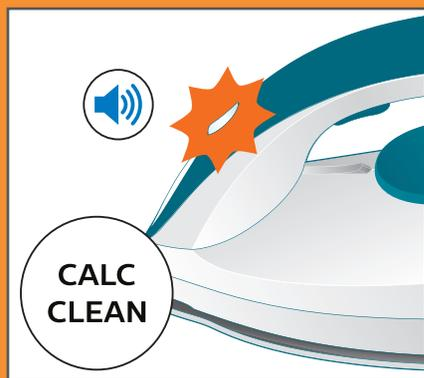
Führen Sie die Entkalkung durch, sobald die Entkalkungsanzeige blinkt und das Gerät Signaltöne ausgibt.
