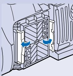
**4** Coloquen el nuevo filtro con su lado blanco mirando hacia el aparato. Asegúrense de que el logo Philips situado sobre el filtro sea visible y esté en la esquina superior derecha.
