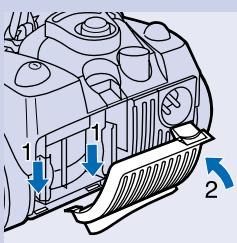
Το Φίλτρο Micro AFS σε αυτή τη συσκευή θα αφαιρέσει ένα μεγάλο μέρος από μικροσκοπικά σωματίδια από τον εξερχόμενο αέρα χρησιμοποιώντας τις ηλεκτροστατικά φορτισμένες ίνες του.
