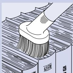
Le suceur à plinthes peut être utilisé pour le nettoyage des coins étroits et des endroits difficiles d'accès.
