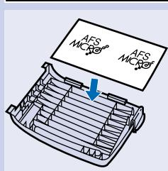
Le Micro Filtre AFS de l'appareil est capable d'extraire de l'air évacué presque toutes les particules de poussière à l'aide de ses fibres chargées électrostatiquement.
