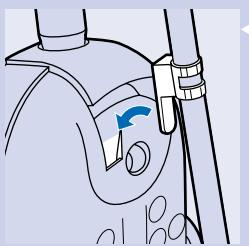
**4** Zet het apparaat rechtop en bevestig de onderste buis aan het apparaat door middel van de clip.
