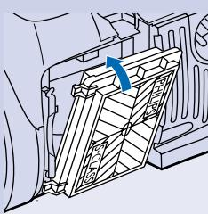
**5** Säkra filtret genom att skjuta tillbaka spärrarna och stänga filterhållaren.
