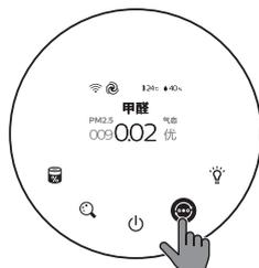
**劲速模式 (⊙):** 空气净化器会以最高速度运行。
