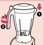
**2** Stavite posudu mješača na vrh motorne jedinice zakretanjem u smjeru strelice dok se ne učvrsti. Ručka mora biti okrenuta ulijevo.
