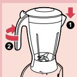
**1** Za pritrstile vrča mešalnika odstranite pokrov z navojem nad kontrolno ploščo.
