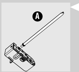
**4** Uklonite cijev usisa s priključkom (A) s elementa za tučenje mlijeka.
