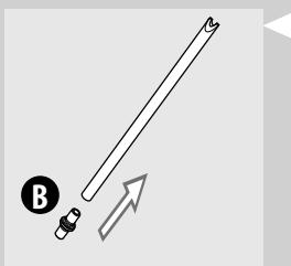
**13** Priključak (B) postavite na cijev usisa.
