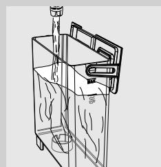
**7** Spremnik napunite svježom vodom do razine CALC CLEAN. Vratite spremnik u aparat. Pritisnite tipku "✓".
