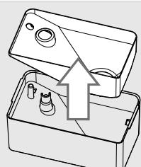
**5** Uklonite pliticu. Pliticu i spremnik očistite vlažnom krpom.
