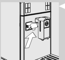
**14** Provjerite da je ispust vode pravilno ugrađen.
