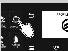
**3** Držite pritisnutu tipku za cappuccino "☕" dok se ne prikaže zaslon prikazan sa strane, zatim pustite tipku. Aparat pamti da je potrebno umetnuti vrč i izvući ispust vrča. Aparat je sada u fazi programiranja.
