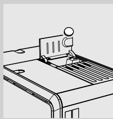
**8** Ubacite jednu tabletu za odmašćivanje u odjeljak za prethodno samljenu kavu. Pritisnite tipku "✓".
