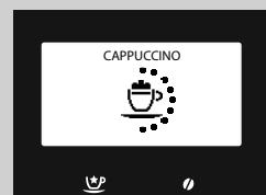
**10** Aparat započinje s ispuštanjem mlijeka. Za prekid ispuštanja, ponovno pritisnite tipku odabranog napitka, ispuštanje će se prekinuti nakon nekoliko sekundi.
