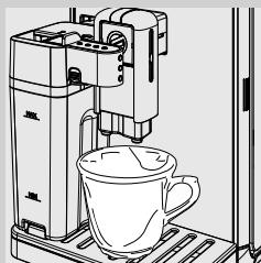
**2** Izvucite ispust vrča udesno sve do simbola "▲". Postavite šalicu ispod ispusta vrča.
