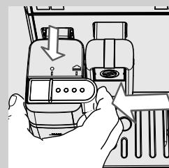
**12** Po završetku ispuštanja, ukoliko ne želite provesti automatski ciklus ispiranja vrča, zatvorite ispušt vrča pomicanjem do simbola “●”.
