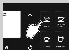
**9** Ispuštanje kave će se automatski prekinuti kad se postigne podešena razina; moguće ga je, međutim, prekinuti ranije ponovnim pritiskom na tipku odabranog napitka.
