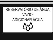
Extraia o reservatório de água e encha-o. Também é possível encher o reservatório utilizando o respectivo orifício na tampa.
