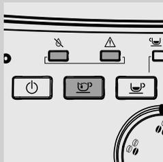
**14** Los pilotos luminosos "⚠" y "⚠" y el piloto luminoso del botón "☕" comenzarán a parpadear rápidamente, lo que indica que es necesario proceder a la carga del circuito hídrico.
