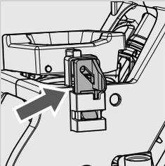
**10** Asegurarse de que el gancho para el bloqueo del grupo de café esté en la posición correcta; para comprobarlo, presionar con fuerza el pulsador "PUSH" hasta que quede enganchado. Comprobar que el gancho esté arriba, en su posición tope. En caso contrario, volver a intentarlo.
