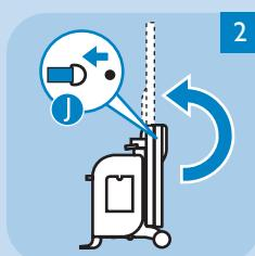
Otpustite sigurnosnu traku za dasku J i postavite dasku za peglanje u vertikalni položaj.
