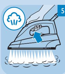
Ako želite da peglate sa parom, podešite regulator temperature na 2 ili na jače i pritisnite prekidač za ispuštanje pare **T**.
