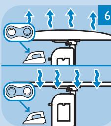
Ako želite da peglate u režimu za izduvavanje, pritisnite zaobljenu stranu dugmeta za izduvavanje/usisavanje. Ako želite da peglate u režimu za usisavanje, pritisnite udubljenu stranu dugmeta za izduvavanje/usisavanje.
