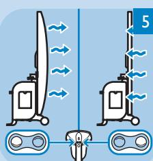
Ako želite da peglate u režimu za izduvavanje, pritisnite zaobljenu stranu dugmeta za izduvavanje/usisavanje. Ako želite da peglate u režimu za usisavanje, pritisnite udubljenu stranu dugmeta za izduvavanje/usisavanje.
