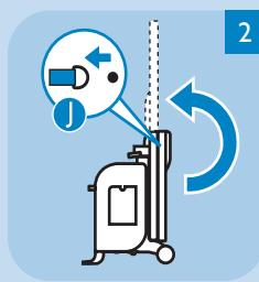
Otpustite sigurnosnu traku za dasku **J** i postavite dasku za peglanje u vertikalni položaj.
