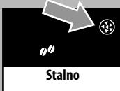
Potreba za provedbom čišćenja kamenca označava se uključivanjem simbola na zaslonu.
