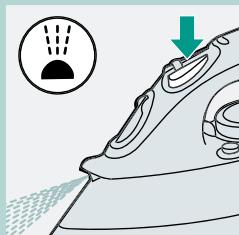
Μπορείτε να χρησιμοποιήσετε τη λειτουργία για να αφαιρέσετε επίμονες τσακίσεις σε κάθε θερμοκρασία.
