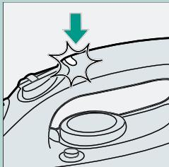
**I** A função electrónica de desligar automático de segurança desliga o ferro se não for movimentado durante algum tempo.
