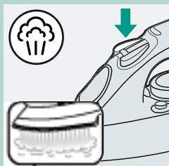
Güçlü bir 'şok' buhar inatçı kırışıklıkların açılmasına yardımcı olur. Şok-buhar fonksiyonu sadece ●● ve MAX arasındaki sıcaklık ayarlarında kullanılabilir.
