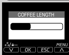
Z reguliranjem kazalnika na zaslonu s tipkami za listanje "V" ali "A" lahko izberete količino vode pri točenju kave.
