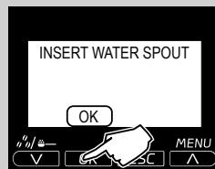
**13** Aparat opozarja, da je potrebno namestiti pipo za točenje vode. Prepričajte se, da je pravilno postavljen. Pritisnite "OK" za potrditev.
