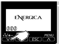
**1** Za začasno spremembo količine zmlete kave pritisnite tipko "V" na nadzorni plošči.
