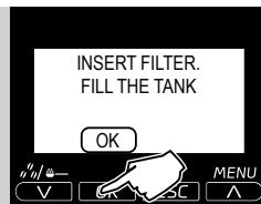
**12** Pritisnite tipko "OK" za potrditev, da ste vnesli vodni filter in napolnili rezervoar.
