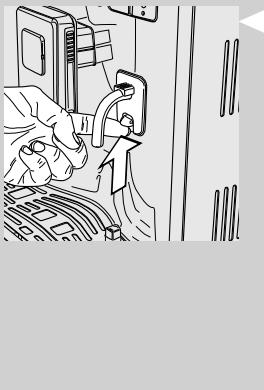
**1** Če je nameščen, odstranite pipo za točenje vode, kot je prikazano na sliki:
