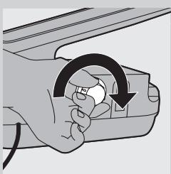
**9** Vyplachovací uzáver na odstraňovanie vodného kameňa naskrutkujte pevne na generátor pary.
