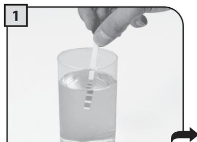
Mergulhe, por 1 segundo na água, o papel para o teste da dureza da água, presente na máquina.
