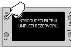
**12** Apăsați tasta „OK” pentru a confirma introducerea filtrului de apă și umplerea rezervorului.
