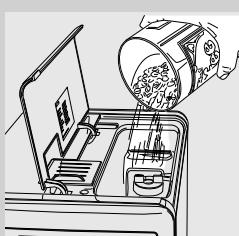
**9** Vărsați ușor boabele de cafea în compartiment. Repozitionați capacul interior și închideți-l pe cel exterior.
