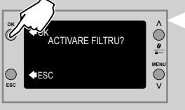
**11** Apăsați tasta „**OK**” pentru a confirma procedura de activare a filtrului.
