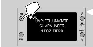
**11** Goliți carafa de lapte și umpleți-o cu apă proaspătă. Introduceți-l la loc în aparat. Apăsați tasta „OK”.
