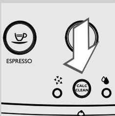
**7** Натисніть і утримуйте кнопку «<sup>CALC</sup>CLEAN» принаймні впродовж 3 сек. для запуску циклу зняття накипу. Кнопка «☕» горить сталим світлом. Кнопка «<sup>CALC</sup>CLEAN» блимає протягом всього циклу.
