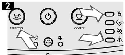
Машина вимагає заправлення системи. Натисніть кнопку «☕». Після натискання кнопка гасне. Під час заправлення системи індикатори «⚡» і «⚠» блимають і гаснуть після завершення заправлення.
