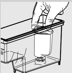
**18** Зніміть невеличкий білий фільтр і поставте на місце водяний фільтр «INTENZA+» (якщо він присутній) у водяний бачок; промийте і наповніть його свіжою водою до позначки MAX. Знову вставте його в машину.
