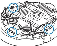
**Remarque :** il est normal que le robot se déplace un peu sur le bord d'une différence de hauteur car son capteur de chute avant est situé derrière le pare-chocs.
