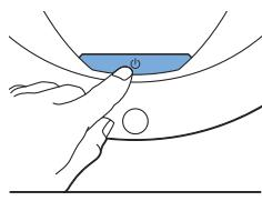
In de diepe-slaapmodus reageert de robot helemaal niet wanneer u op een knop drukt. U kunt de robot als volgt weer inschakelen wanneer deze zich in de diepe-slaapmodus bevindt:
