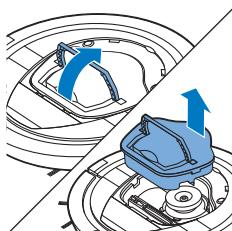
Opmerking: Wanneer u de stofbak uit de robot haalt of terugplaast, moet u er goed op letten dat u de bladen van de motorventilator niet beschadigt.
