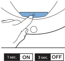
**1** Drücken Sie eine Sekunde lang die Start-/Stopp-Taste auf dem Roboter, um den Roboter aus dem Schlafmodus in den Standby-Modus zu versetzen.
