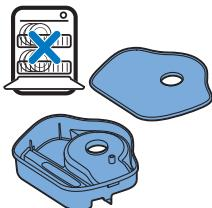
**Let op:** Maak de stofbak en het filter niet schoon met water en plaats deze onderdelen ook niet in de vaatwasmachine.
