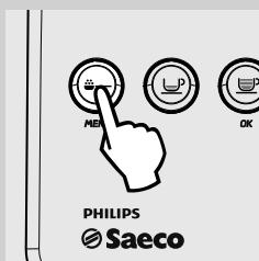
**3** Odaberite funkciju ispuštanja prethodno mlevene kafe jednim pritiskom na taster “
