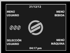
**14** Una vez suministrada toda el agua necesaria para el ciclo de enjuague, la máquina termina automáticamente el proceso de descalcificación mostrando esta pantalla tras una breve fase de calentamiento.
