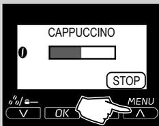
**7** Kad se na zaslonu prikaže sljedeći ekran, ispuštanje pjene od mlijeka je u tijeku. Ispuštanje se može prekinuti ranije pritiskom na tipku "MENU".
