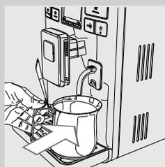
5 Nakon dovršetka ispuštanja, ispraznite spremnik i vratite ga ispod ispusta vode.
