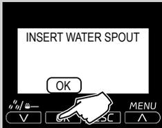
**13** Aparat traži da ugradite ispušt vode. Uvjerite se da je pravilno postavljen. Pritisnite "OK" za potvrdu.
