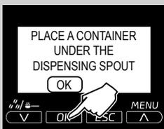
**6** Postavite spremnik (1,5 l) ispod ispusta kave. Pritisnite tipku "OK" za pokretanje ciklusa čišćenja.
