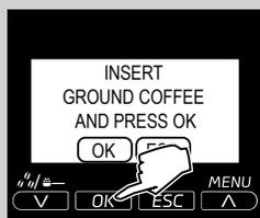
4 Pritisnite tipku "OK". Aparat započinje ispuštanje vode.
