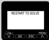
Zabilježite kod (E xx) koji se prikazuje pri dnu zaslona. Iskljuete aparat. Ukljuete ga ponovno nakon 30 sekundi. Postupak ponovite 2 ili 3 puta. Ukoliko se aparat ne pokrene, kontaktirajte vruuu liniju Philips SAECO u svojoj zemlji i prijavite kod prikazan na zaslonu. Kontakti su navedeni u posebnoj Jamstvenoj knjiuici ili na stranici [www.philips.com/support](http://www.philips.com/support).
