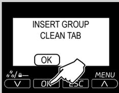
**5** Ubacite jednu tabletu za odmašćivanje u odjeljak za prethodno samljevenu kavu. Pritisnite tipku "OK".
