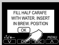
**11** Ispraznite vrč za mlijeko i napunite ga svježom vodom. Vratite ga natrag u aparat. Pritisnite tipku "OK".
