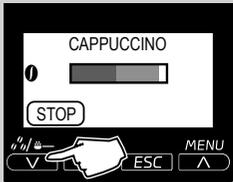
**8** Nakon završetka ispuštanja pjene od mlijeka, aparat ispušta kavu. Ispuštanje se može prekinuti ranije pritiskom na tipku “
