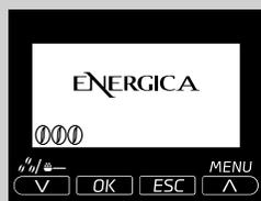
**14** Kada se sva voda potrebna za ciklus ispiranja ispusti, aparat automatski završava postupak čišćenja kamenca i prikazuje ovaj ekran nakon kratke faze zagrijavanja.
