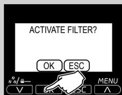
**11** Pritisnite tipku "OK" za potvrdu da želite pokrenuti postupak aktiviranja filtera.
