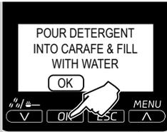
**10** Pritisnite tipku "OK" za pokretanje ciklusa. Aparat započinje ispuštanje otopine kroz ispust mlijeka.
