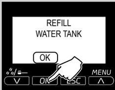
**12** Nakon završetka ispuštanja, spremnik napunite svježom vodom do razine MAX. Pritisnite tipku "OK" za potvrdu.
