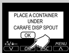
**12** Ispraznite spremnik i ponovno ga stavite ispod ispusta kave i mlijeka. Pritisnite tipku "OK".
