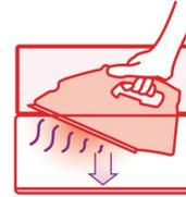
Cette boîte de rangement thermo-résistante est conçue pour ranger facilement le fer chaud. Pour obtenir des performances optimales et prolonger la durée de vie de votre boîte, débranchez le fer et videz le réservoir avant de ranger le fer dans la boîte. Lorsque vous rangez un fer chaud dans la boîte, le fond extérieur de la boîte devient également chaud, mais il n'y a aucun risque de brûlure.
