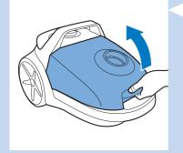
3 Ziehen Sie den Motorschutzfilter aus dem Halter.
