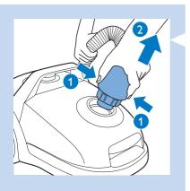
2 Um den Schlauch abzuziehen, drücken Sie die Entriegelungstasten auf dem Schlauchanschluss (1), und ziehen Sie den Schlauch aus dem Gerät (2).
