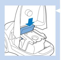
4 Schieben Sie den neuen Motorschutzfilter in die Halterung.
