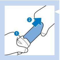
3 Zum Lösen des Rohrs vom Handgriff halten Sie den SmartLock fest (1), und ziehen Sie den Griff aus dem Rohr heraus (2).
