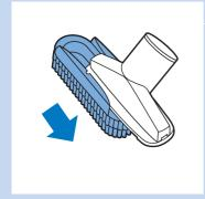
4 Um die Düse vom Rohr zu trennen, halten Sie den SmartLock fest, und ziehen Sie das Rohr aus der Düse.
