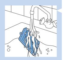
Hinweis: Reinigen Sie den HEPA-Filter nie mit einer Bürste. Eine Reinigung stellt die ursprüngliche Farbe des Filters nicht wieder her. Die Filterleistung wird jedoch wiederhergestellt.
