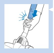
1 Richten Sie die Erhöhung auf dem Schlauch an der Aussparung im SmartLock der Düse aus. Drücken Sie das Rohr in die Düse, bis Sie ein Klicken hören.
