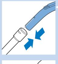
1 Richten Sie die Erhöhung auf dem Handgriff des Schlauchs an der Aussparung im SmartLock des Rohrs aus. Drücken Sie den Handgriff ins Rohr, bis Sie ein Klicken hören.
