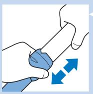
2 Um das Rohr auf die Länge einzustellen, mit der Sie am bequemsten saugen können, nehmen Sie die Rohrlängenarretierung, und drücken Sie sie nach unten, oder ziehen Sie sie nach oben.
