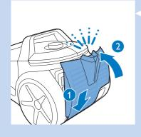
Hinweis: Es gibt einen schwarzen Filter im Filtergitter. Diesen Filter müssen Sie nicht herausnehmen, reinigen oder ersetzen.
