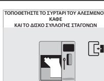
Τοποθετήστε το δοχείο συλλογής στερεών υπολειμμάτων και το δίσκο συλλογής υγρών.
