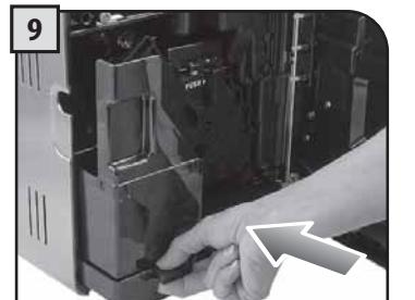
Τοποθετήστε το δοχείο συλλογής στερεών υπολειμμάτων και κλείστε το πλαϊνό καπάκι.
