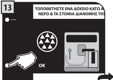
Τοποθετήστε το δοχείο κάτω από το ακροφύσιο καθώς και ένα δοχείο κάτω από το σωλήνα ζεστού νερού. Στη συνέχεια πατήστε "OK".
