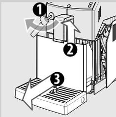
**16** Para limpar a bandeja de limpeza, coloque no interior da bandeja uma pastilha desengordurante e encha-a até 2/3 com água quente. Deixe a solução de limpeza actuar durante cerca de 30 minutos e, em seguida enxagúe abundantemente.
