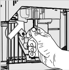
**5** Limpe bem a conduta de saída do café com o utensílio adequado para a limpeza fornecido com a máquina ou com a pega de uma colher. Certifique-se de que insere o utensílio adequado para a limpeza conforme indicado na figura.
