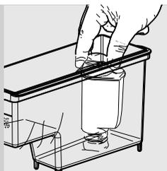
**20** Retire o pequeno filtro branco e reposicione o filtro de água "INTENZA+" (se presente) no reservatório de água; enxagúe-o e encha-o com água fresca até ao nível MÁX. Reintroduza-o na máquina.
