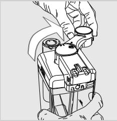
**1** Aprire l'erogatore della caraffa del latte ruotandolo in senso orario.
