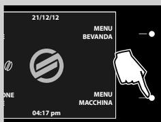
**4** A questo punto è possibile programmare le impostazioni di durezza dell'acqua. Premere il tasto "MENU MACCHINA" per accedere al menu principale della macchina.
