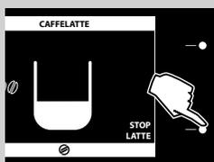
7 Quando viene visualizzata la schermata a lato, la macchina avvia l'erogazione di latte. Per interrompere l'erogazione in anticipo, premere il tasto “**STOP LATTE**”.
