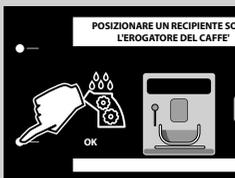
**6** Posizionare un contenitore (1,5 l) sotto l'erogatore del caffè. Premere il tasto "OK" per avviare il ciclo di pulizia.
