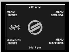
**14** Quando tutta l'acqua necessaria per il ciclo di risciacquo è stata erogata, la macchina termina automaticamente il processo di decalcificazione e mostra questa schermata dopo una breve fase di riscaldamento.
