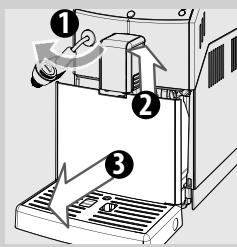
**16** Для очистки поддона для сбора капель поместите внутрь него таблетку для удаления кофейного масла и наполните его на 2/3 горячей водой. Дайте чистящему раствору подействовать в течение приблизительно 30 минут, затем тщательно ополосните поддон.
