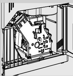
**12** Ополоснув блок приготовления кофе, вставьте его обратно в гнездо так, чтобы он защелкнулся в нужном положении (см. главу «Еженедельная чистка блока приготовления кофе»). Вставьте поддон для сбора капель и контейнер для сбора отходов. Закройте дверцу для обслуживания.
