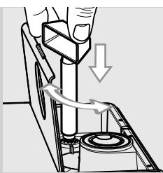
**2** Пока машина перемалывает, нажмите и поверните ручку для регулировки помола, расположенную внутри емкости для кофе в зернах, только на одно деление за раз. Используйте специальный ключ для регулировки кофемолки, поставляемый в комплекте. Разница вкуса будет ощутимой после подачи 2-3 кофе.
