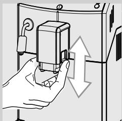
Для выполнения регулировки приподнимите или опустите вручную устройство подачи кофе с помощью пальцев, как показано на рисунке.
