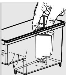
**4** Вставьте фильтр для воды «INTENZA +» в пустой бак для воды. Сдвиньте его как можно ниже.
