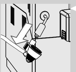
**1** Снимите автоматический вспениватель молока с трубки пара.
