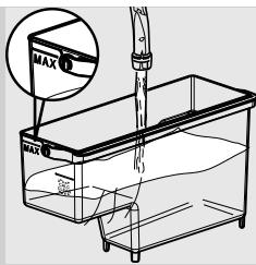
**5** Ополосните бак для воды свежей водой.
