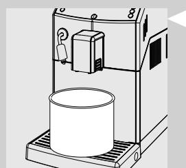
**12** Опорожните емкость и установите ее под трубку пара/горячей воды и устройство подачи кофе.
