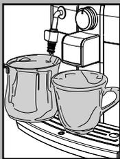
6 Placer un récipient vide sous la buse de vapeur et un autre sous la buse de distribution.
