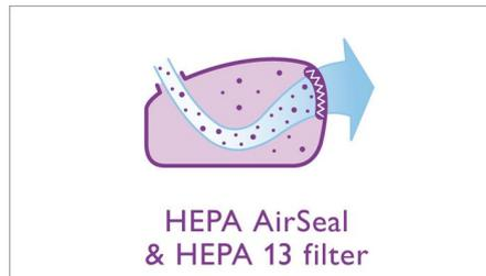
Ovaj usisavač tvrtke Philips dizajniran je tako da se sav zrak koji ulazi prije ispuštanja usmjerava kroz filter HEPA 13 koji se može prati (filtracija od 99,95%). Ništa ne propušta.
