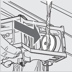
**5** 用乾淨的溫水徹底沖洗沖煮系統，然後仔細清潔上部濾水器。
