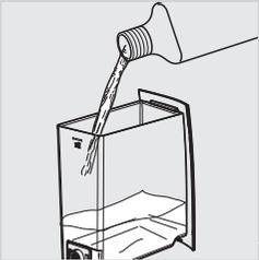
6 取下水箱然後向其中倒入整個包裝容量的 Sacco 除鈣劑。然後注入清水到水箱中，直到最高水平。
