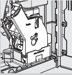
**3** 將沖煮系統插入其底座直至卡入定位。（參閱“「每週清洗沖煮系統」章節）。插入咖啡殘渣槽。
