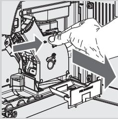
**9** 取出咖啡粉槽並打開服務門。先取出咖啡殘渣槽，再取出沖煮系統。
