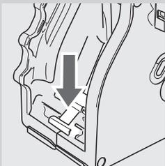
**9** 輕輕拉下控制桿，直到它接觸沖煮系統底座，和兩個在沖煮系統旁的參考標誌匹配為止。
