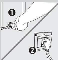
**10** Introducir la clavija en la toma de corriente ubicada en la parte trasera de la máquina.
