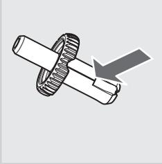
**19** Asegurarse de que no queden restos de leche en la ranura del racor (véase flecha en la figura de la izquierda). En caso contrario, no será posible montar leche. Limpiar a fondo con un paño húmedo abrasivo.
