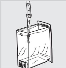
**11** A continuación, volver a llenar el depósito de agua hasta el nivel MAX. La máquina ya está lista para el suministro de café. Se mostrará la pantalla indicada a la izquierda.
