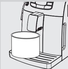
**8** Colocar un recipiente grande (1,5 l) bajo el tubo de vapor/agua caliente y la salida de café.
