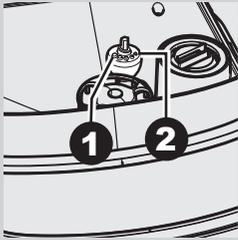
**2** Las referencias presentes dentro del contenedor de café en grano indican el grado de molido configurado. Se pueden configurar 5 grados de molido diferentes, que van de:
