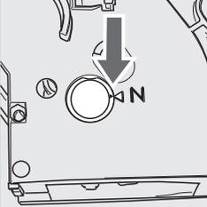
**9** Presionar delicadamente la palanca hacia abajo hasta que toque la base del grupo de café y hasta que las dos marcas de referencia del lateral del grupo de café coincidan.
