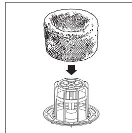
**9** 将清洗后的加湿滤网和滤网架装回水箱。
