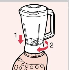
**3** Monter kannen på motorenheten. Vri den i pilens retning til De hører et klikk.
