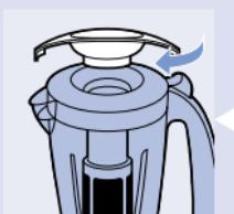
**4** 從蓋子的開口將食材置於濾網中。加入的材料，不可超出濾網的金屬部分，不可使用濾網處理熱的食材。
