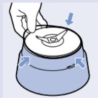
**2** 确定橡胶垫正确安放在刀片单元上。
