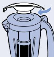
**6** 安装上带有保护卡的塞子，然后打开设备电源。选择最高的速度，最多可以让设备运转40秒。
