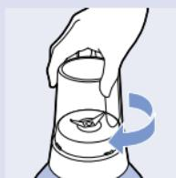
**4** 将安装好的研磨器上下翻转，并按箭头所示的方向将其固定在电动机单元上。
