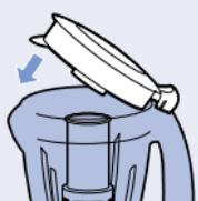
**2** 将缸盖盖在缸体上，以便将过滤器固定到正确的位置。
