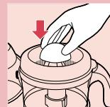
**2** Ruotate il setaccio nella direzione della freccia fino a quando il perno del blocco di sicurezza si inserisce nel gruppo motore.
