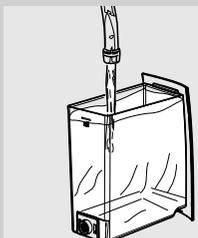
**12** Βγάλτε το δοχείο νερού, ξεπλύνετε το και γεμίστε το με φρέσκο νερό έως τη στάθμη MAX. Επανατοποθετήστε το στη μηχανή.
