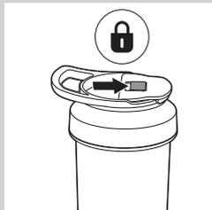
**9** 关闭饮水嘴并将锁定滑块推到锁定位置将其锁定。
