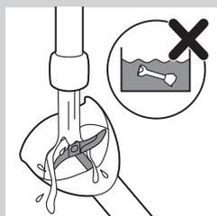
**9** 为便于清洁，请在使用后立即用热水冲洗。切勿将搅拌棒完全浸入水中。
