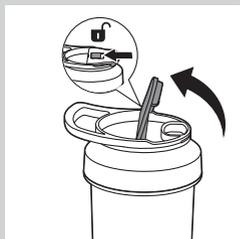
**11** 将锁定滑块推到开启位置将饮水嘴打开。
