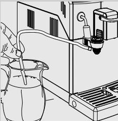
**3** Inserire il tubo di aspirazione nel contenitore.
