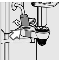
**18** Verificare che sia correttamente posizionato. Se non si riesce ad inserire si deve ruotare la copertura cromata. Il Montalatte Automatico è montato correttamente quando il dente s'inserisce nella scanalatura.
