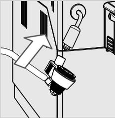
**4** Inserire il Montalatte Automatico nella sede del tubo vapore.
