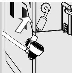
**27** Inserire il Montalatte Automatico nella protezione in gomma.
