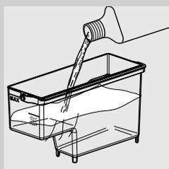
**4** Estrarre il filtro acqua "INTENZA+" (se presente) dal serbatoio dell'acqua e sostituirlo con il filtrino bianco originale. Versare tutta la soluzione decalcificante nel serbatoio acqua.
