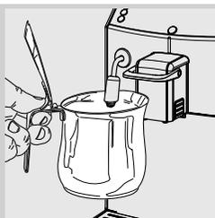
**2** Posizionare un contenitore sotto il tubo vapore.
