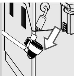
**2** Sfilare il Montalatte Automatico dal tubo vapore/acqua calda.
