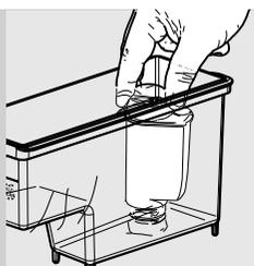
**4** Inserire il filtro acqua "INTENZA +" nel serbatoio vuoto dell'acqua. Spingerlo fino al punto più basso possibile.
