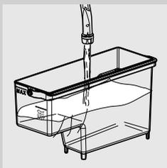
**10** Estrarre il serbatoio dell'acqua, risciacquarlo e riempirlo con acqua fresca fino al livello CALC CLEAN. Reinsierlo nella macchina.
