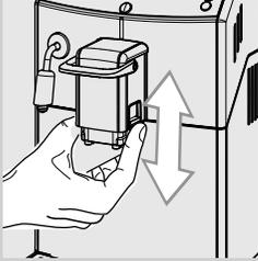
Per effettuare la regolazione, alzare o abbassare manualmente l'erogatore caffè con le dita come mostrato in figura.
