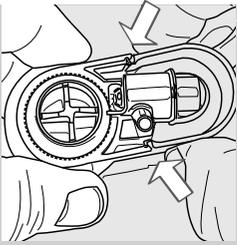
**23** Montare il Montalatte Automatico nel raccordo assicurandosi che sia ben fissato nelle sedi evidenziate.
