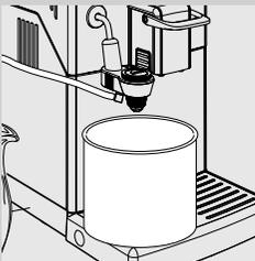
**4** Posizionare un contenitore capiente (1,5 l) sotto il Montalatte Automatico.
